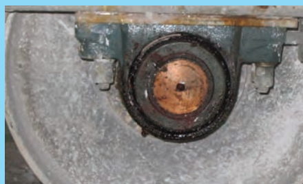
Este sobrecalentamiento en el eje y el rodamiento puede ser un indicio de un fallo en el rodamiento, de una lubricación insuficiente o de una mala alineación.
